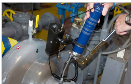
Łatwy montaż do większości smarownic
