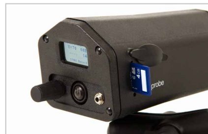
Dane smarownicze mogą być zapisywane na karcie pamięci SD
